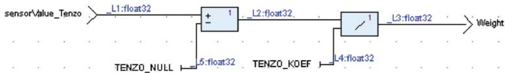
Рис. 10. State4: оператор для тарировки тензодатчика
