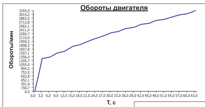
Рис. 22. Графики изменения тяги и оборотов двигателя в процессе испытания
