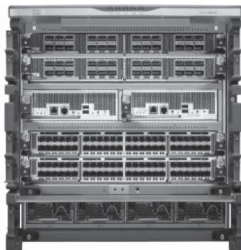
всех критичных компонентов, включая коммутационные матрицы. Модель имеет малую область отказа, предсказуемые и стабильные показатели задержки и пропускной способности. В Cisco MDS 9706 Director реализованы коррекция ошибок FEC и многоточечная проверка CRC.
