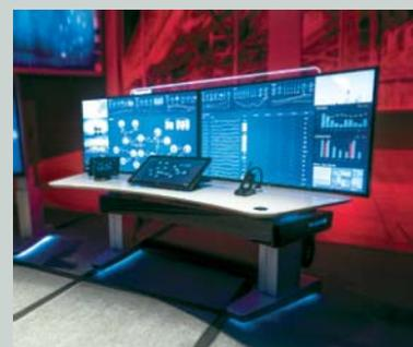
**49** Пульт Experion Orion компании Honeywell и место для совместной работы объединены в более эргономичную композицию, с более крупной и гибкой экранной поверхностью, с навигацией для панорамирования
