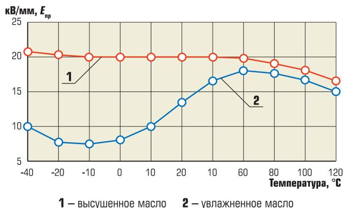
Рис. 1. Зависимость электрической прочности трансформаторного масла от температуры
