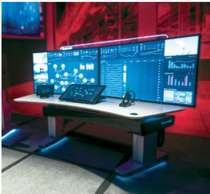
Рис. 1. После года исследования работы операторов в диспетчерских, пульт Exregion Oligo компании Honeywell и место для совместной работы объединены в более эргономичную композицию, с более крупной и гибкой экранной поверхностью, с навигацией для панорамирования (выбора изображаемого участка, прокрутки текстов) и масштабирования, с подсвечиванием предупреждений об окружающей обстановке. Honeywell Process Solutions
