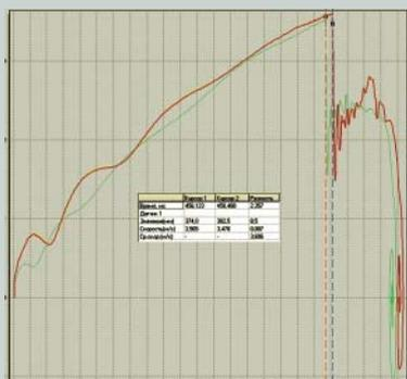
**20** Операция включения. График зависимости скорости от хода траверс фаз «А», «В» и «С»
