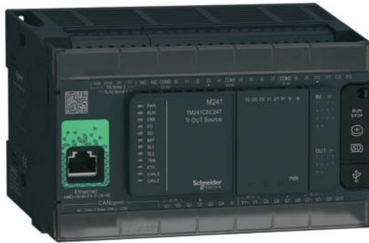
Рис. 9. Внешний вид контроллера Modicon M241
