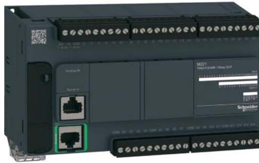
Рис. 6. Внешний вид контроллера Modicon M221
