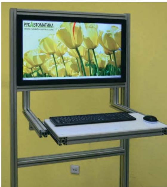
Рис. 7. Стойка с промышленным панельным компьютером
