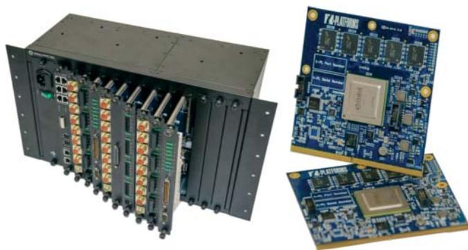
Рис. 18. Контроллер и платы для открытой платформы АСУ ТП и ЧПУ
