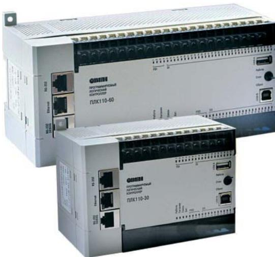
Рис. 2. Моноблочный контроллер ОВЕН ПЛК110 [M02]
